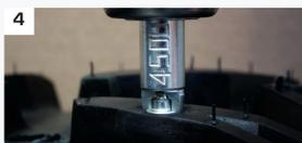
4 Затянуть до упора головки ключа в поверхность протектора
