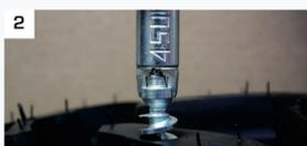
2 Установите опорный виток шипа на поверхность протектора шины или подошвы ботинка в необходимом месте
