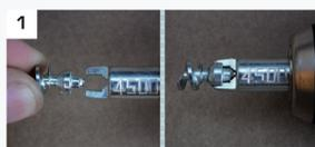
1 Вставьте головку шипа в наконечник монтажного инструмента
