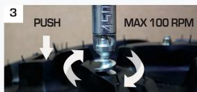
3 С силой надавите на шип в продольном направлении. При постоянном равномерном усилии ввернуть шип в протектор, выдерживая заданный угол наклона. Медленно затяните шип с помощью электрической отвертки или ручной ручки
